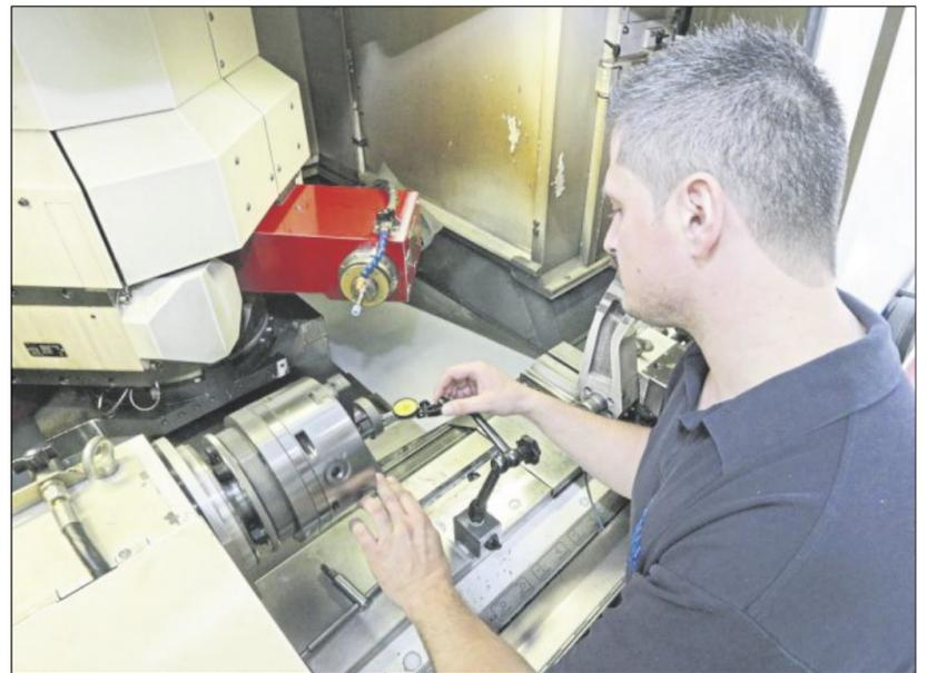
Mitarbeiter prüft den Rundlauf eines zum Schleifen eingespannten Werkstückes.
