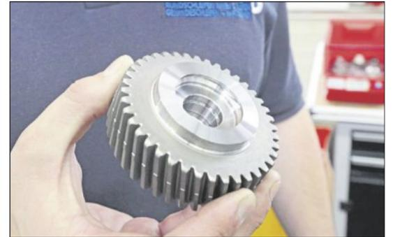
Geschliffenes Zahnrad für ein Getriebe. Foto: Steinemann
